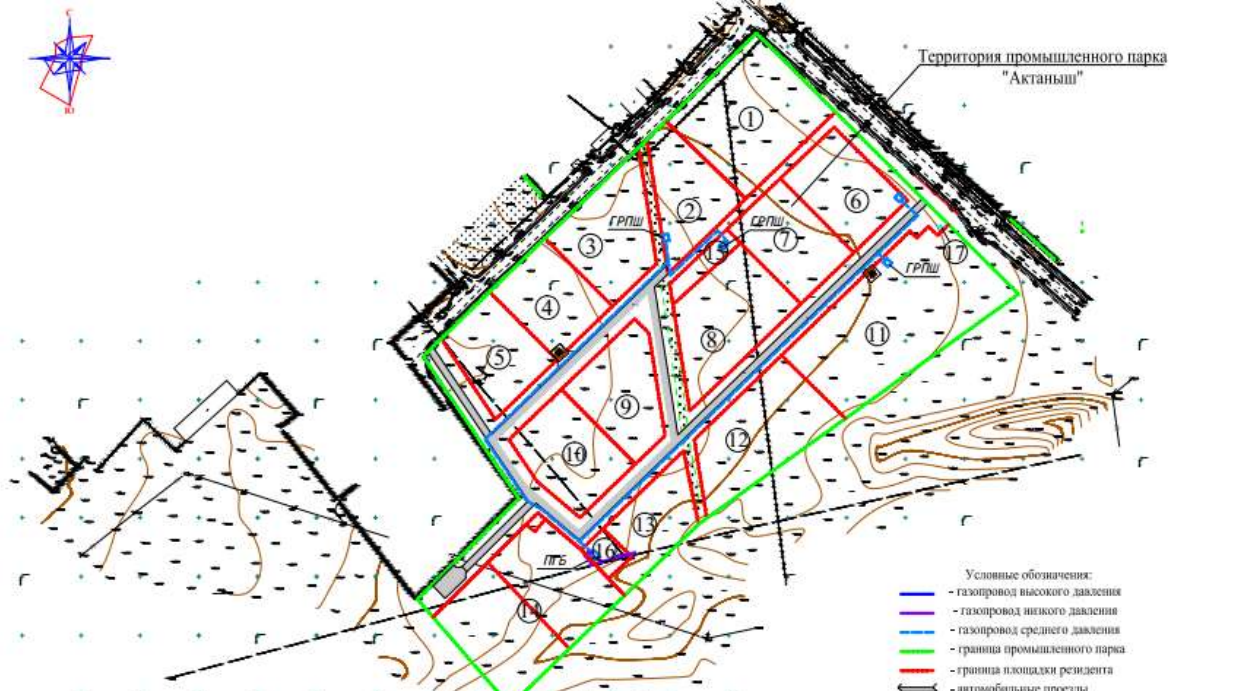
Схема прокладки сетей газоснабжения
