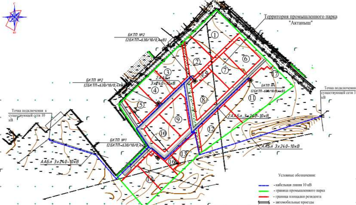
Схема прокладки кабельной линии 10 кВ
