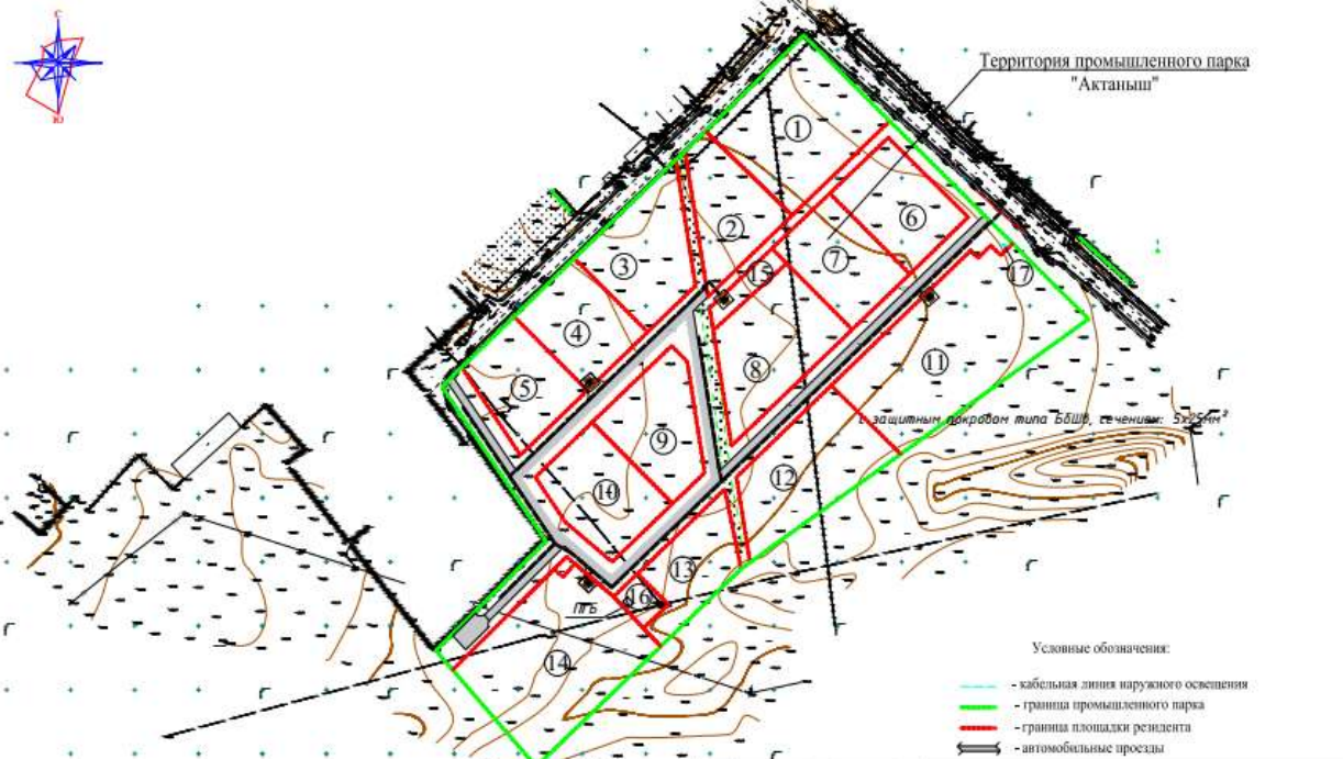
Схема прокладки кабельной линии наружного освещения
