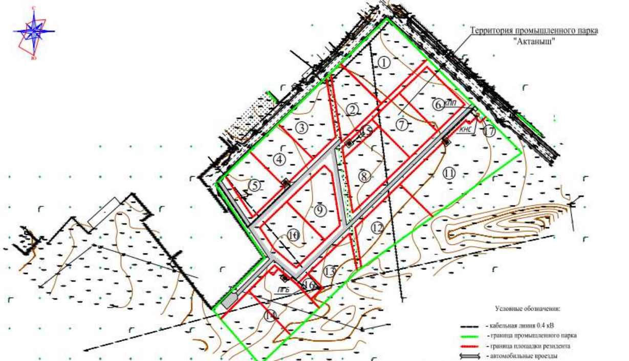
Схема прокладки кабельной линии 0,4 кВ
